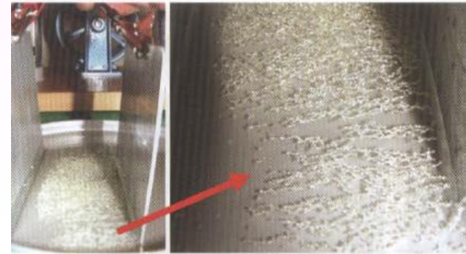
Fot. 6. Obraz linii pola elektrycznego między dwoma równoległymi płytkami – elektrodami
