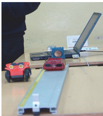
Rys. 4. Samochód na baterie (po lewej stronie) porusza się na poziomym stoliku, a wózek na poziomej szynie aluminiowej (foto A. Karbowski).
