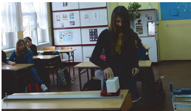
Rys. 2. Wózek z pudełkiem odbijającym fale ultradźwiękowe na równi pochyłej. Uczennica wykonuje doświadczenie podczas zajęć kółka fizycznego w Gimnazjum nr 1 w Chełmży, które przeprowadził autor (foto A. Karbowski).
